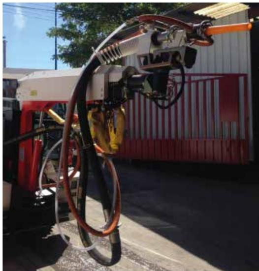
La Duodécima cuenta con un brazo extraíble de tres tramos, por lo que el rango de trabajo es muy amplio. La Duodécima puede gunitar en un rango que oscila entre menos de 2 metros hasta 7 metros en sentido horizontal y 13 metros en sentido vertical (9 metros hacia arriba y 4 hacia abajo)
